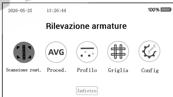
Fig.3.2 Interfaccia principale per la rilevazione delle armature
